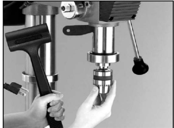
2. Gire el eje hasta que la ranura interior esté alineada con la exterior, como se muestra en la Figura de arriba.
