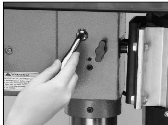
2. El motor debe poder moverse libremente. Gire la palanca de tensión de la correa en sentido antihorario para quitar la tensión de las correas trapecoidales como se muestra en la Figura superior.
