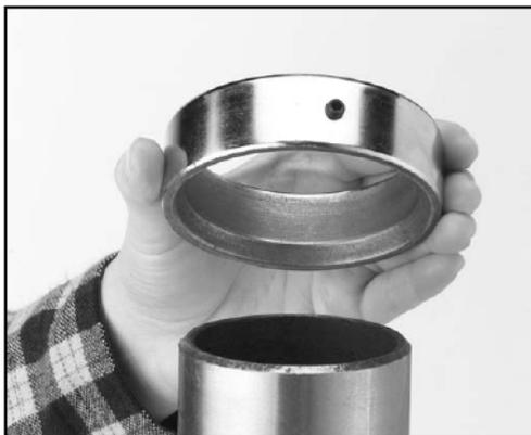
5. Deslice el anillo de la columna en la columna con el bisel interior en la posición hacia abajo como se muestra en la Figura. Ajuste el anillo hasta que la punta de la cremallera encaje dentro del bisel. Apretar el tornillo de fijación en el anillo.
