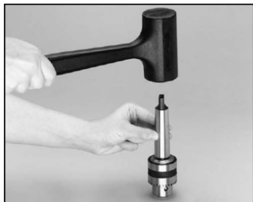
El portabrocas se fija al husillo. Para ensamblar el portabrocas y montarlo en el eje, siga cuidadosamente estos pasos:
